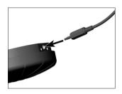
Inserire il cavo di ricarica nella presa di carica del controllo al piede.
