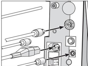
**2** Motorkabel, Bedienelement, Luftschlauch (Perfecta 600), Fußanlasser (optional) und Netzkabel anstecken.
