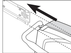
**3** Steuergerät bis auf Anschlag auf das Halteblech aufschieben.
