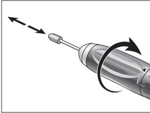
❶ Vordere Griffhülse bis auf Anschlag nach rechts drehen. Rotierendes Werkzeug bis auf Anschlag einschieben oder herausnehmen.
