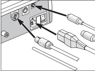
**1** Motorkabel, Bedienelement (optional), Luftschlauch (Perfecta 600) und Netzkabel anstecken.
