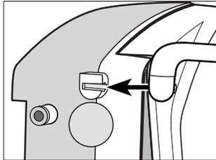
**1** Bügel für Ausblasfunktion bis auf Anschlag aufschieben.
