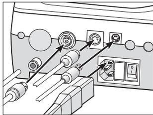
**1** Motorkabel, Bedienelement, Fußanlasser, Luftschlauch (Perfecta 600) und Netzkabel anstecken.
