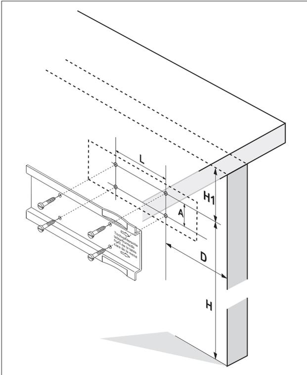
① Mit der beiliegenden Bohrschablone oder Halblech Schraubenlöcher anzeichnen.
