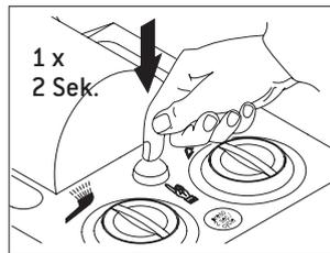
Drücken Sie den Startknopf 1 mal für ca. 2 Sekunden. Öffnen Sie die Kuppel nach dem Pflegevorgang.
